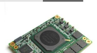
LX-3580 是为嵌入式控制提供的超小体积、超低功耗、高性能工业级CPU模块,模块采用高速32位CPU、高速大容量内存;用户可灵活扩展串口、以太网、键盘、鼠标、USB、CRT及LVDS等功能。此模块特别适合于超小体积、低功耗、高可靠的嵌入式应用。
