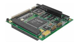
F5-VFP是一款基于PC/104+结构的视频输入输出、显示功能模块,支持模拟CVBS信号输入、 composite video和s-video输出外,还支持CRT、EL和TFT LCD显示器。通过PC/104+总线可与其它 的PC/104+模块堆栈,为嵌入式系统提供高性能的视频处理及显示功能。特别适合低功耗、高可靠、 嵌入式应用的要求。
