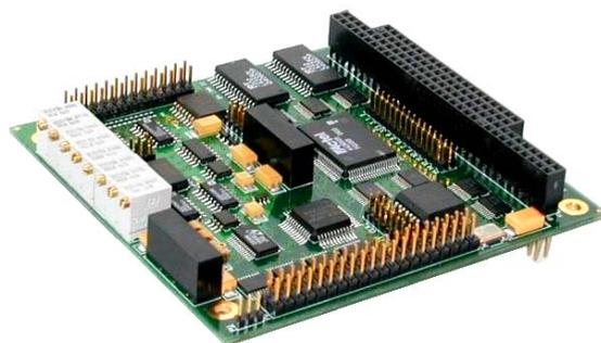
ADT-800 是一款基于PC/104 结构的AD/DA、DIO、计数器、定时器功能模块。通过PC/104总线可构成一个高性能的数据采集与控制系统。适用于结构紧凑、高可靠的嵌入式应用。
