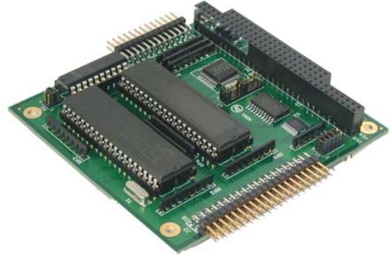
AM-CDT800是一款基于PC/104结构的数字IO、定时/计数器功能模块，通过PC/104总线可与其其它的PC/104模块堆栈，为嵌入式系统提供高性能的控制功能。适用于结构紧凑、高可靠的嵌入式应用。
