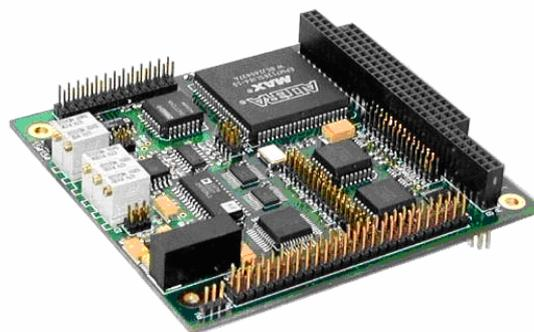
ADT-700 是一款基于PC/104 结构的AD/DA、DIO、计数器、定时器功能模块。通过PC/104总线可构成一个高性能的数据采集与控制系统。适用于结构紧凑、高可靠的嵌入式应用。
