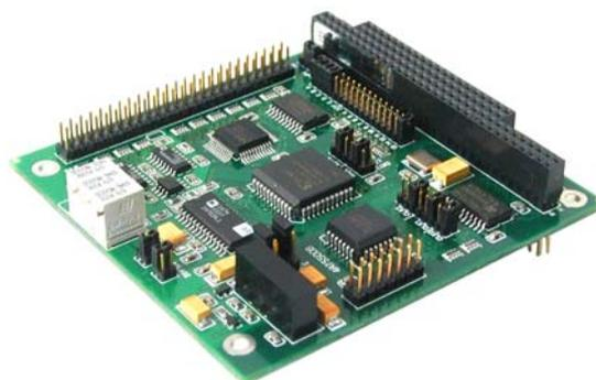
ADT-620 是一款基于PC/104结构的AD采集、DIO、计数器、定时器功能模块。通过PC/104 总线可构成一个高性能的数据采集与控制系统。适用于结构紧凑、高可靠的嵌入式应用。
