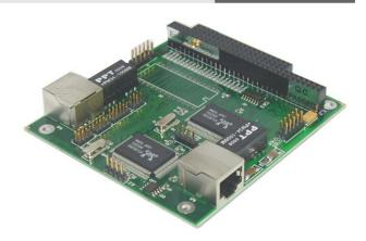
RT-DETH是一个基于PC/104 结构的10M~20M双网络通信功能模块。通过RT-DETH的PC/104 总线可以与其它的PC/104模块,构成一个高性能的网络通讯与控制的嵌入式系统。适用于结构紧凑、高可靠的嵌入式应用。
