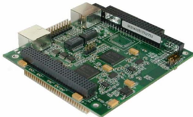
IT-DETH 是一个基于 PC/104+结构的 10M/100M 双以太网通信功能模块。通过 IT-DETH 的 PC/104+ 总线可以与其它的 PC/104+模块，构成一个高性能的网络通讯与控制的嵌入式系统。适用于结构紧凑、高可靠的嵌入式应用。
