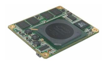
LX-3560 是为嵌入式控制提供的超小体积、超低功耗、高性能工业级 CPU 模块,模块采用高速 32 位 CPU、高速大容量内存;用户可灵活扩展串口、并口、硬盘、以太网、键盘、鼠标、USB、CRT 及平板显示等功能。此模块特别适合于超小体积、低功耗、高可靠的嵌入式应用。
