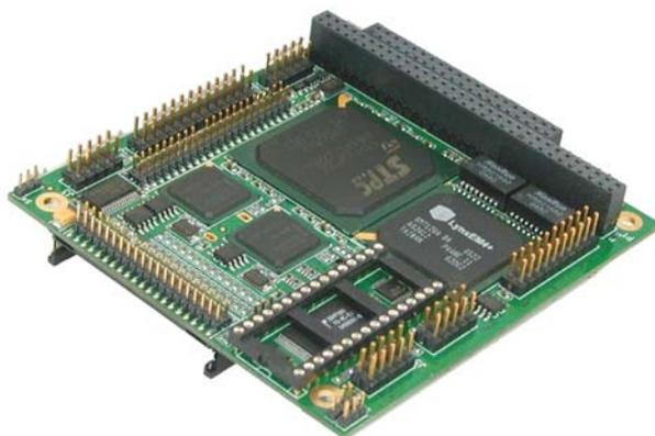
STV-2050 为嵌入式控制提供了高性能的工业级 CPU 模块，模块上除设计有高速 32 位的 CPU、表贴内存、显示、串口、并口、软硬盘接口、以太网接口、键盘、鼠标、USB 等标准功能外，还提供平板显示器支持、看门狗等嵌入式控制功能，特别适合低功耗、高可靠、嵌入式控制的要求。
